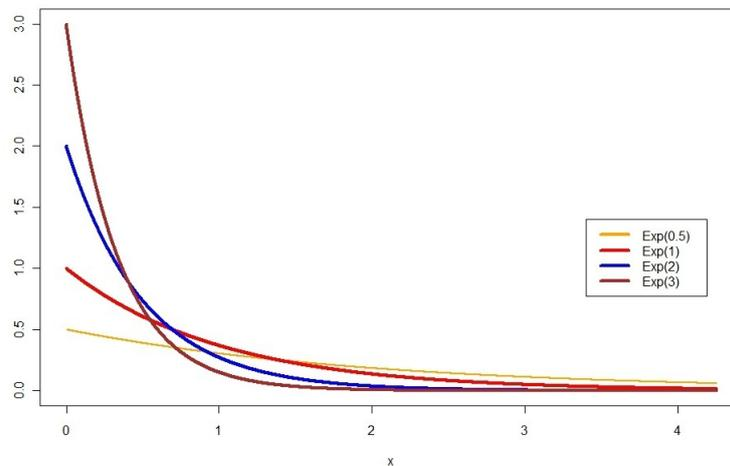
Abbildung 7.5: Dichtefunktionen von exponentialverteilten Zufallsgrößen mit unterschiedlichen Parametern
